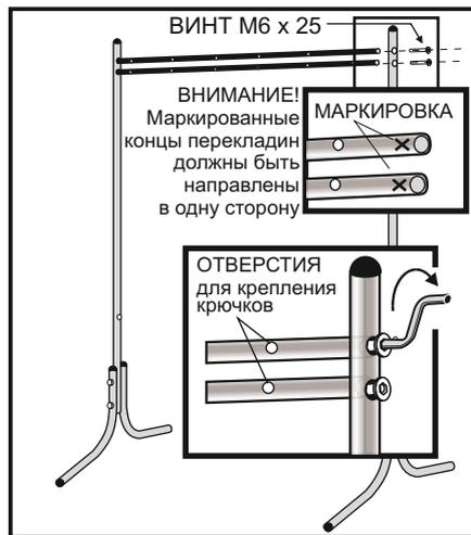
2.2. Заверните между стоек НИЖНЮЮ ПЕРЕКЛАДИНУ. Винтами, прилагаемыми в комплекте, зафиксируйте соединение. ЗАТЯНИТЕ СОЕДИНЕНИЕ ДО УПОРА ключом 4.
