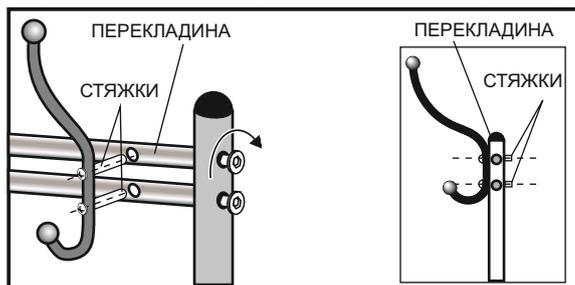
3.2. Вставьте в крючки винты M4x20 и вверните их в стяжки с помощью отвёртки
